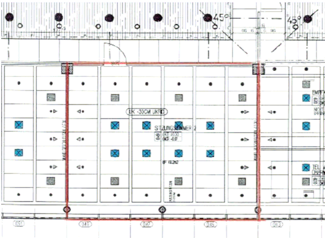
Beleuchtungsplan für Sitzungszimmer mit Einbauleuchten in der Raummitte und Akzentleuchten am Rand des Raumes
