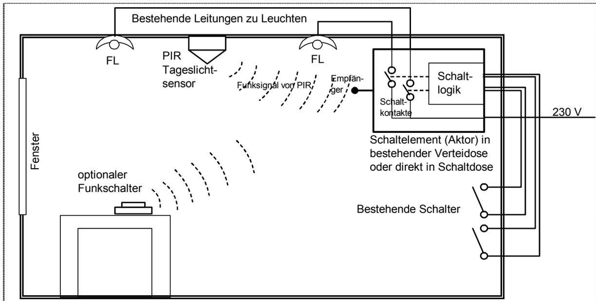
**Fig. 1** Prinzipschema für eine Nachrüstung einer Beleuchtung mit zwei oder mehr geschalteten Beleuchtungsgruppen. Der Aktor kann entweder in der Verteildose oder direkt in der Schaltdose untergebracht werden
