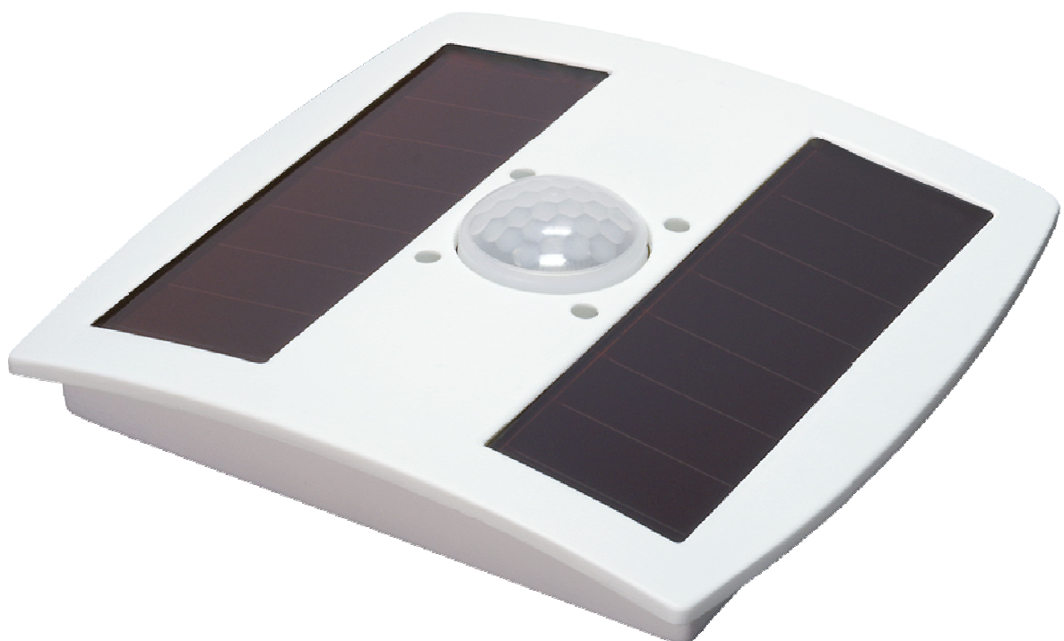
Figur 5: Der neu entwickelte SESOLUX Funk-Präsenzmelder. Zwei Indoor-Photozellen (dunkle Streifen) erzeugen die für den Betrieb des Präsenzmelders notwendige Energie.
